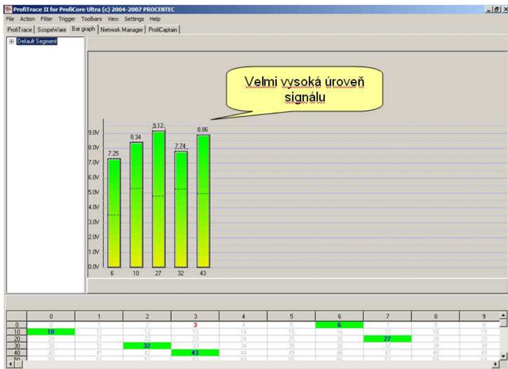
Obr. 11 – Sloupcový diagram v případě, že je zjištěno chybějící zakončení nebo přerušovaný kabel
